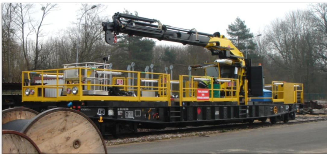
Grue auxiliaire « intermédiaire » (ici montée sur un wagon)
