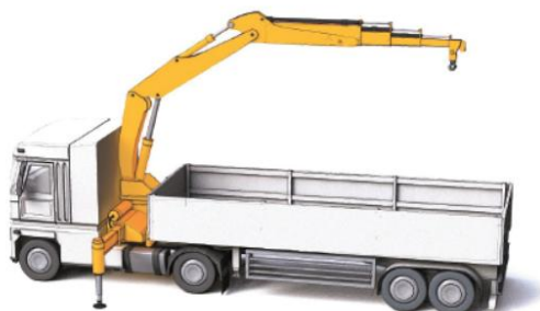
Grue de chargement montée derrière la cabine
