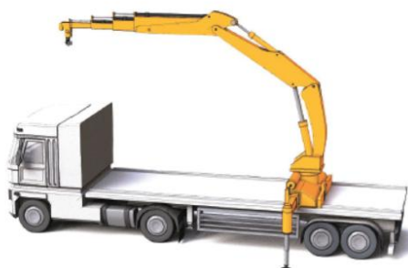
Grue de chargement montée en position centrale
